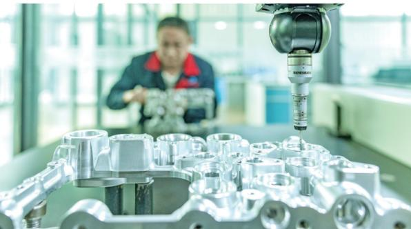
4月18日,在日照德信机械制造有限公司,工程师在对产品进行精度测量。
